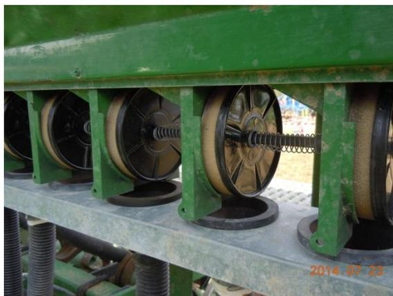
[Figure 46](#) : Semoir Aitchison avec une distribution mécanique à mousse
